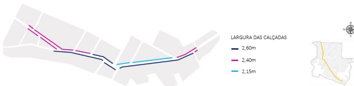
Figura 4: Larguras propostas para as calçadas - Av. Eleutério Fernandes de Andrade. Fonte: Os autores, 2019.
